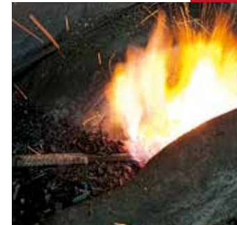
松炭を燃やし鋼を熱する「沸かし」では、鍛錬所の温度は五十度以上になる。
