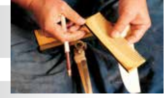
歯が仕上がると、続いて持ち手の側の加工に入る。糸鋸で成型し、鉋で肩を丸めた後、木賊で磨き込む。
