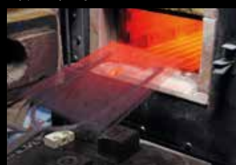
③焼きあがり、電気炉から生地を取り出した瞬間。
