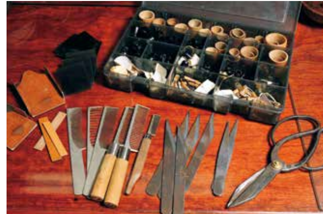
左から、毛先を揃える寄せ金・手板。毛をそろえるときに使う金櫛。「さらい」で使用する小刀。鋏。ケースに入っているのは芯の太さを測るツボ。
