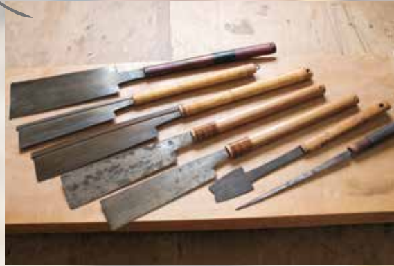
代表的な鋸。上から順に両刃、柄引き、胴付き、縦引き、横引き、畦引き、廻し引きの各種鋸。
