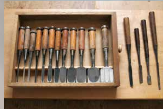
鑿の種類。箱に入っているのが叩き鑿12種。箱の外に置かれているのが突き鑿4種。
