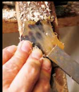
③ 粗削り：ガンギやヤスリ、小刀で甲羅に付いた傷などを削り落として整える。
