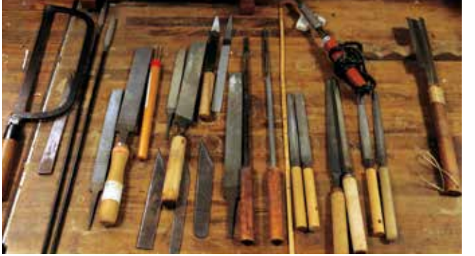
尺八製作に用いる鑿(やすり)、鑿(のみ)、鋸(のこ)などの工具各種。
