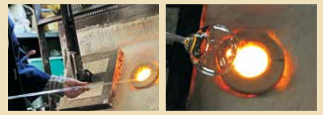
右はガラスを溶かす専用の炉。中には素焼きの坩堝(るつぽ)が2つ埋め込まれている。江戸風鈴は薄手のため、ガラスが早く固まりやすい。ガラスが固まる前に成型を行なうため、窯場には2人1組で立つ。
