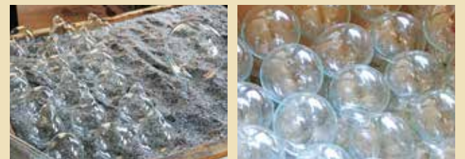
共棒から切り落とされた口玉。ガラスの厚さ、玉の大きさ、切り口の具合ですべて「意識して大きさを変えている」のだとか。わずか1gの差が、微妙な音質も微妙に変わる。一見、同じサイズに見えるが本体はすべて「意識して大きさを変えている」のだとか。わずか1gの差が、微妙な音色の違いを生み出す。
