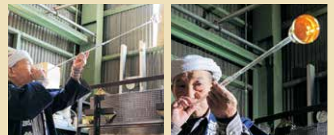
型を使わずに昔ながらの宙吹きという技法を使うのも、江戸風鈴の特徴だ。宙吹きに要する時間は、たったの3秒。まさに瞬間の勝負だ。
