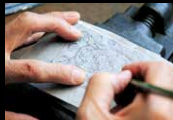
③ヤニ台に載せたアルミ板を仕事機の万力で固定し、図柄を転写する。
