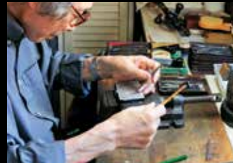
④金槌を操りながら、タガネで図柄に沿って彫っていく。
