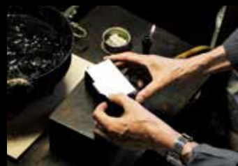
②温めたヤニ台にアルミ板を載せる。
