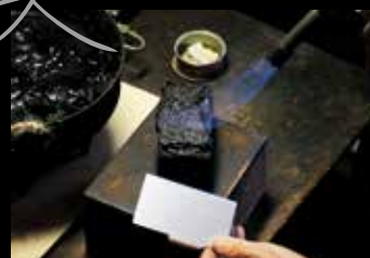
①ヤニ台をガスバーナーで温める。
