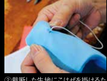
② 裁断した生地にはこはぜを掛けるための糸を通し、縫い付け、表地に通した掛け糸が、こはぜを掛けたとき動かないよう、糸を通した端を縫う。それから外甲になる生地にこはぜを縫いつける。
